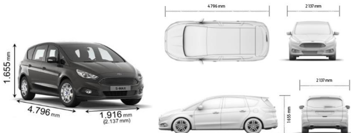
Obrázek č. 29 – Ford S-MAX – rozměry karoserie 57,58
