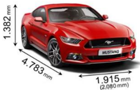
Obrázek č. 27 – Ford Mustang – rozměry karoserie 53
