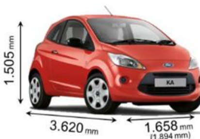
Obrázek č. 19 – Ford KA – rozměry karoserie 33
