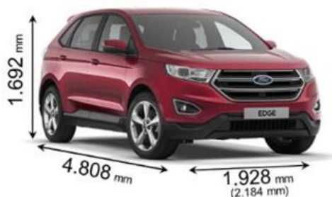
Obrázek č. 28 – Ford Edge – rozměry karoserie 55
