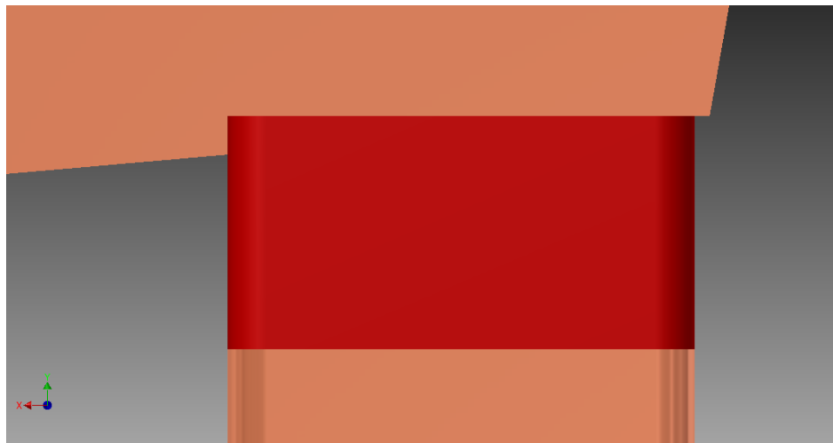
Obr. 5.7: Detail plošného styku
