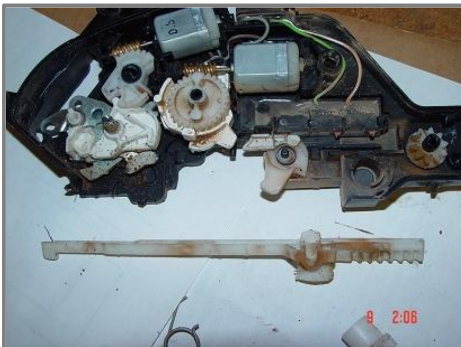
Obr. 1-15 Elektrická část zámku po prachové zkoušce [2]
