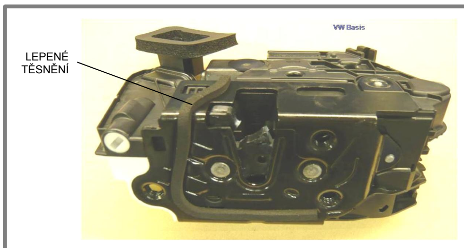
Obr. 1-10 Zámek VW BASISSCHLOS, lepené těsnění [2]
