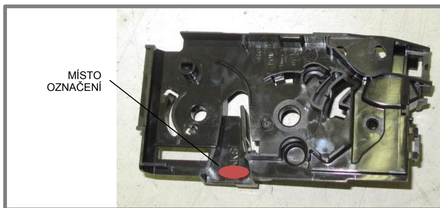
Obr. 1-11 Označovaný díl zámku
