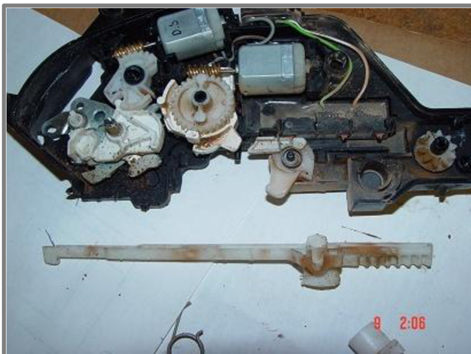
Obr. 1-15 Elektrická část zámku po prachové zkoušce [2]
