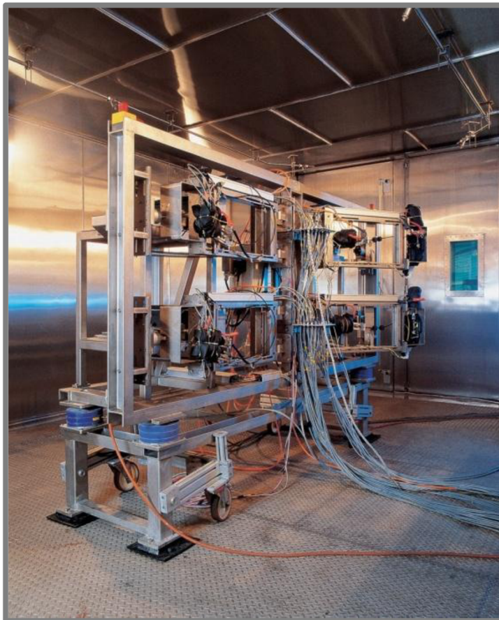
Obr. 1-16 Zkušební stolice v klimatizované komoře [2]
