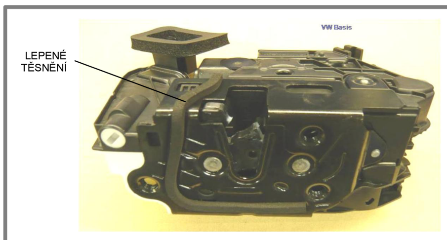
Obr. 1-10 Zámek VW BASISSCHLOS, lepené těsnění [2]
