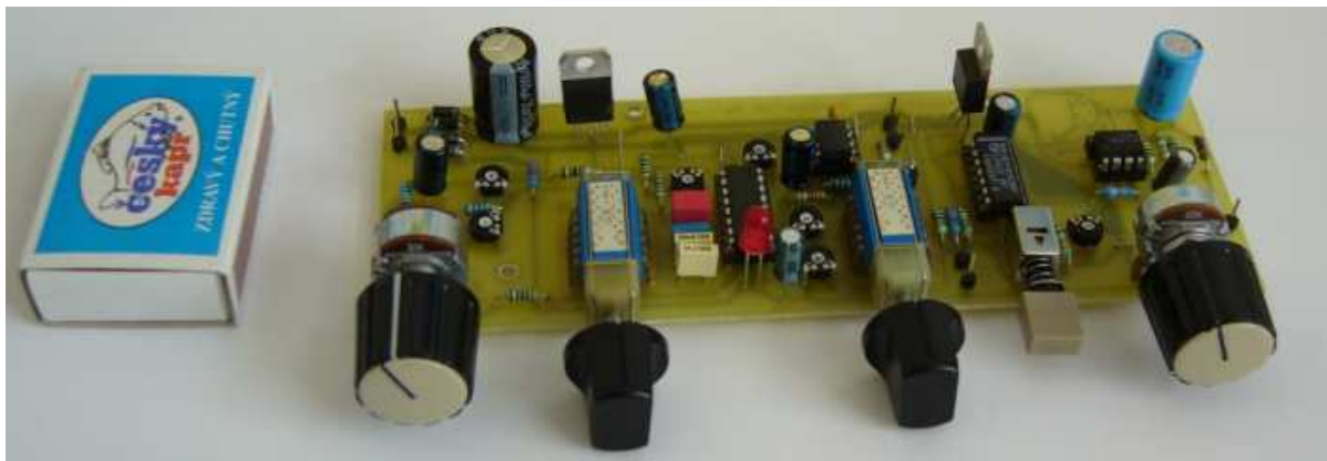
Obr. č. 24 Fotografie sestaveného a upraveného generátoru [4]
