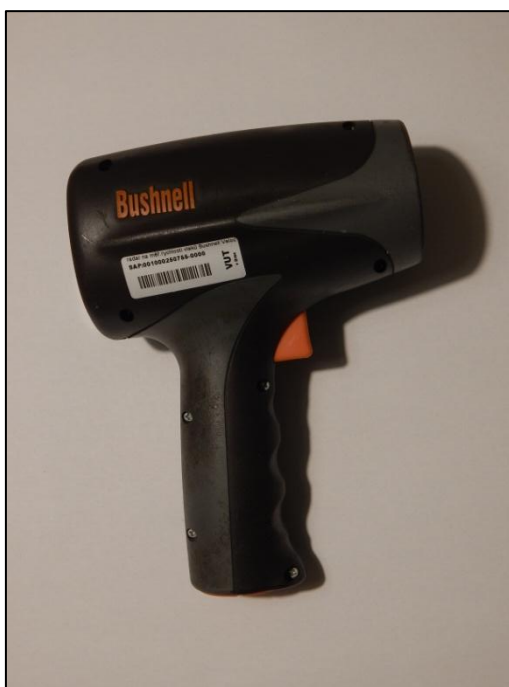
Obrázek 13: Ruční radar Bushnell Speed Radar Gun
