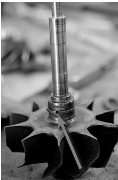
Obr. 17 Hřídel turbodmychadla s turbínovým kolem a pístním kroužkem[18]
