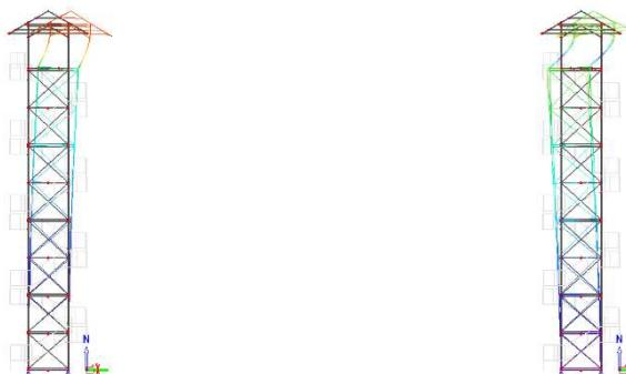
Obr. č. 69 – Vlastní tvary kmitu ve směru osy y ( $f_1 = 1,5301 \text{ Hz}$ ,  $f_2 = 3,1914 \text{ Hz}$ )
