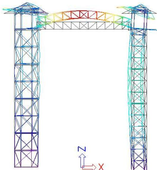
Obr. č. 92 – Model M1, KM 1,  $f = 8,484 \text{ Hz}$
