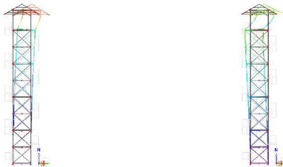
Obr. č. 69 - Vlastní tvary kmitu ve směru osy y ( f_1 = 1,5301 Hz, f_2 = 3,1914 Hz)
