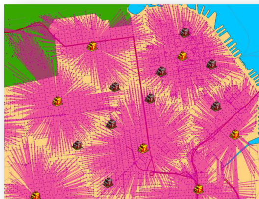
Obr. č. 24 - Location - Allocation, príklad hasičských staníc, ktorých prevádzkovanie môže byť pozastavené a neporuší sa tým pokrytie všetkých miest s časovou dostupnosťou 3 min.
