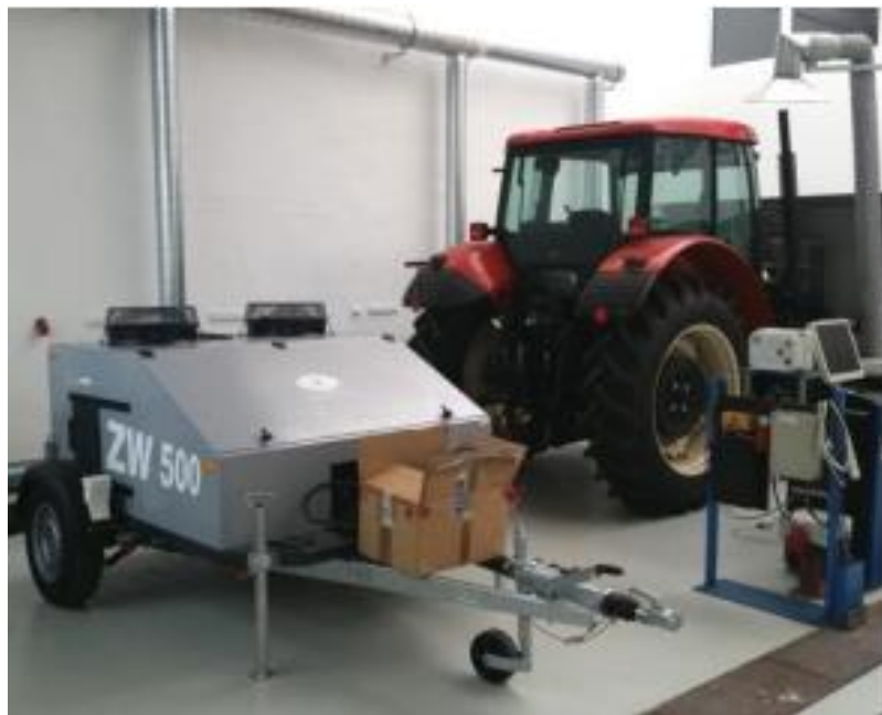
Obrázek 8 - Zetor Forterra 8641 s připojeným dynamometrem MAHA ZW 500
