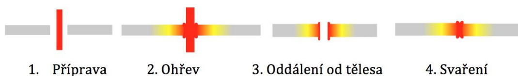
Obrázek 7: Postup svařování horkým tělesem
