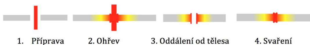
Obrázek 7: Postup svařování horkým tělesem
