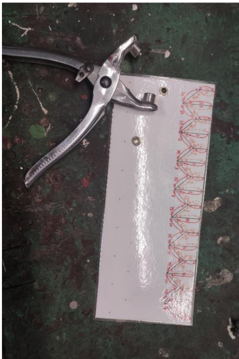
Zpevnění dírky pomocí nýtovacích kleští a textilní průchodky
