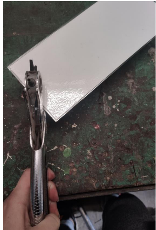
Vytvoření dírky pomocí děrovacích kleští
