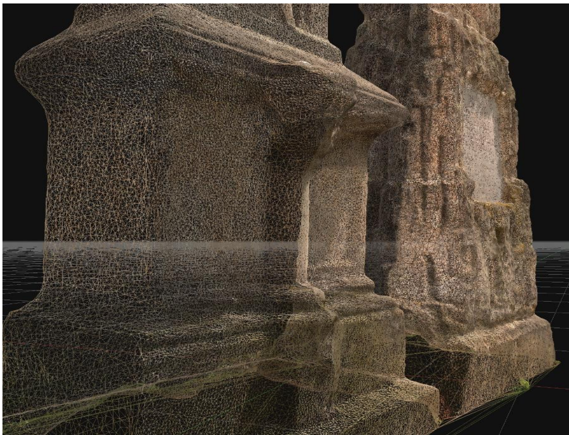
Obr. 8 Znáznornění polygonové sítě typu TIN 3DF Zephyr. 69
