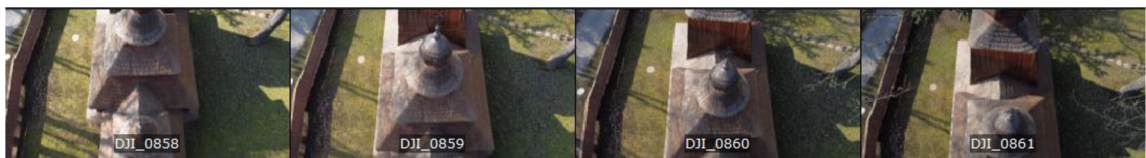
Obr. 16 Ukázka posuvu mezi jednotlivými snímky a vzájemného překrytí. 149
