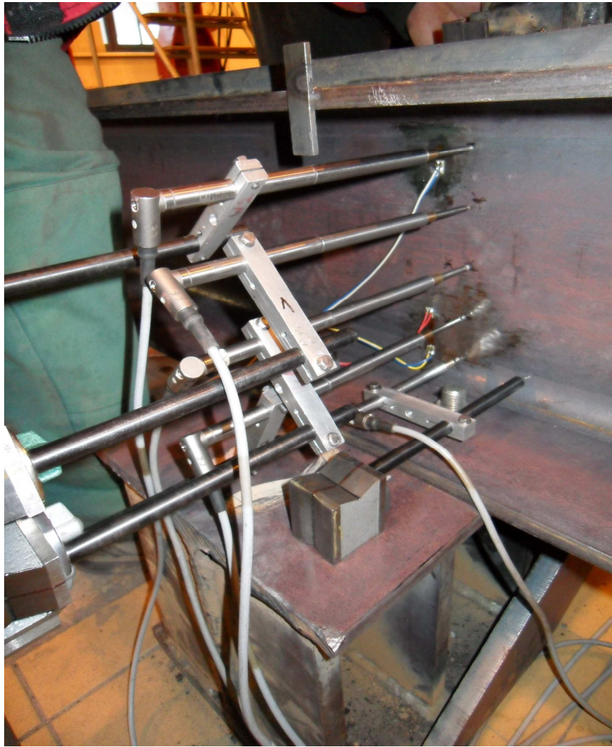
Obrázek 10.23 – Ilustrační záběr upevnění snímačů posuvů a tenzometrů.
