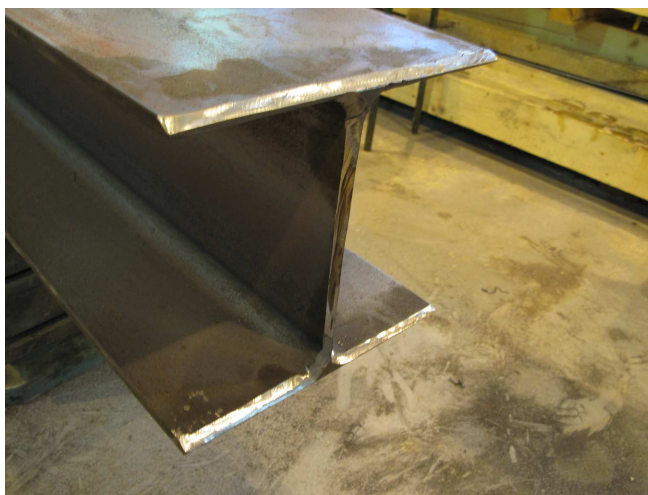
Obrázky 10.2 ↑ a 10.3 → Úkosy pro svarový spoj napojení válcované tyče HEA 300.
