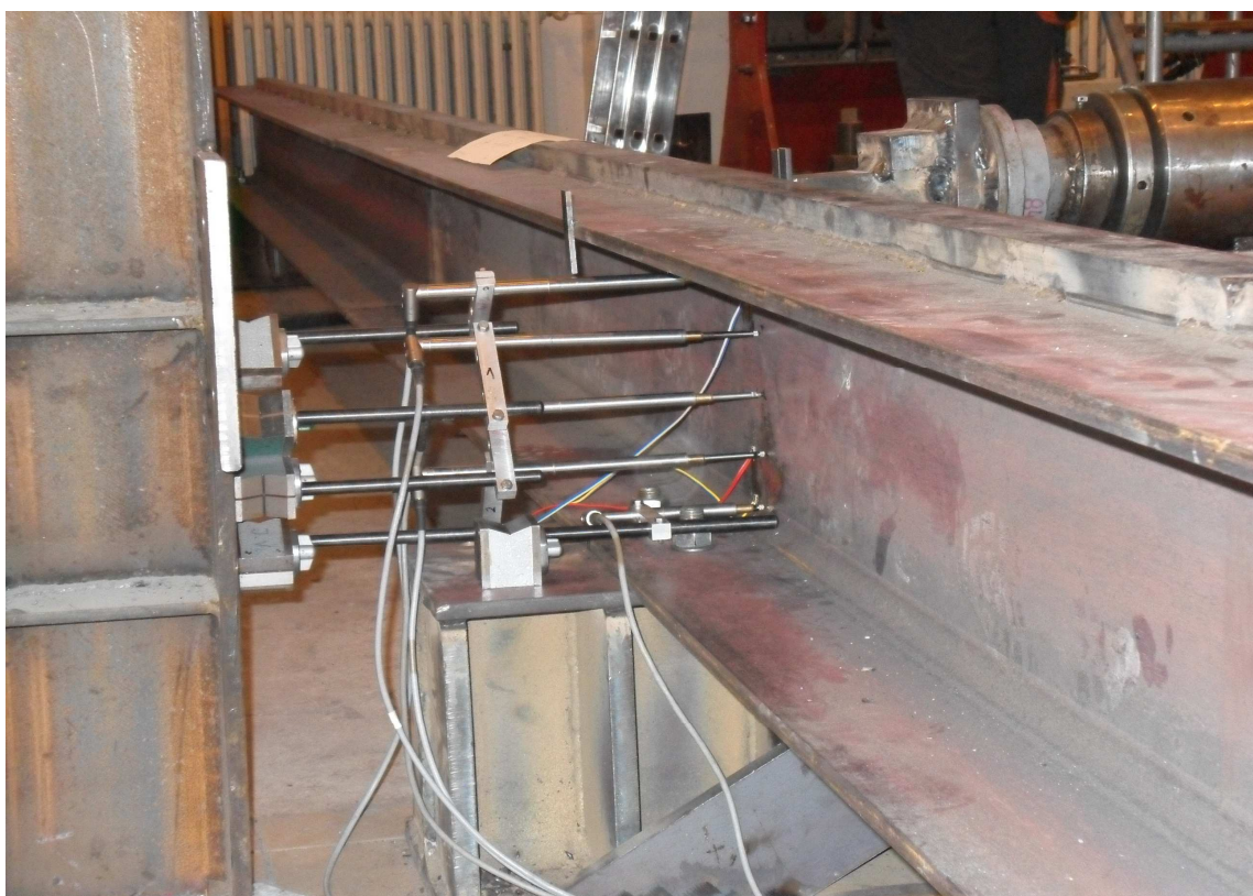
Obrázek 10.22 – Ilustrační záběr upevnění snímačů posuvů a tenzometrů.
