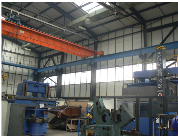
Obrázek 2.3 - Typová hala HARD PJ-18-8,7, zesílení jeřábové dráhy pro jeřáb Hopax 12,5t, Blansko.
