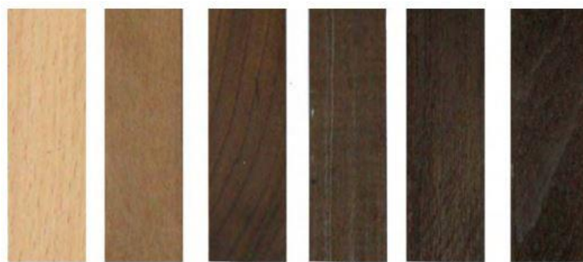
Obrázek 7 - Barevné změny termicky modifikovaného dřeva (Prokom, 2020)
