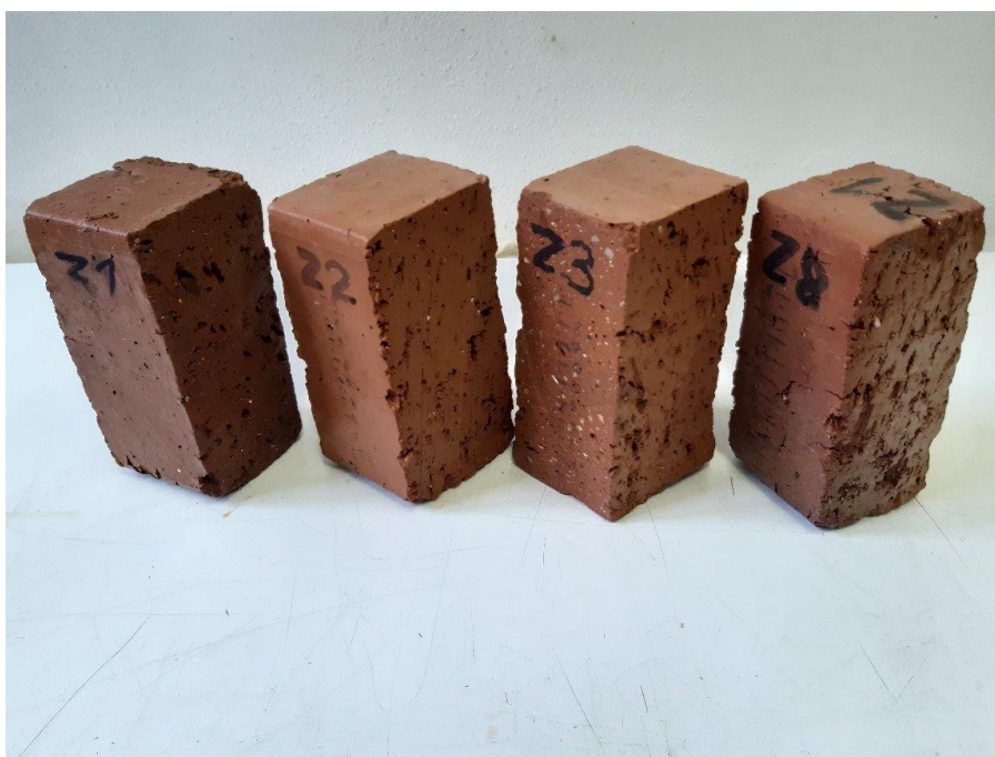
Obrázek 33 Vzorky Z po zkoušce mrazuvzdornosti
