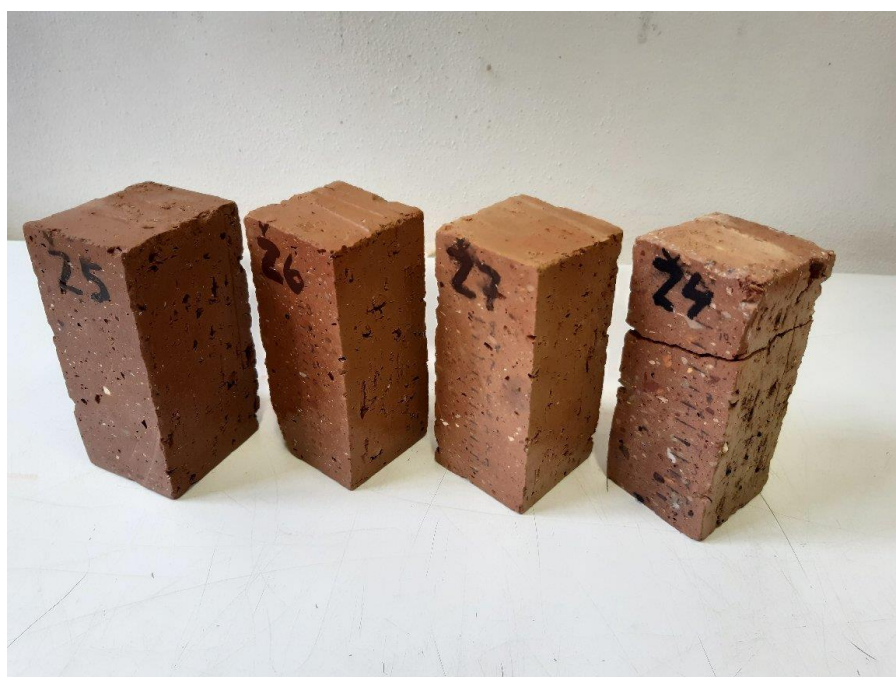
Obrázek 31 Vzorky Ž po zkoušce mrazuvzdornosti
