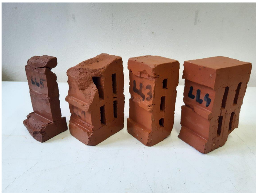
Obrázek 36 Vzorky LL po zkoušce mrazuvzdornosti
