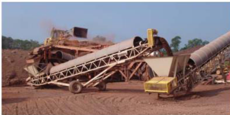
Obrázek 6 Mletí a doprava zeminy na haldy [11]
