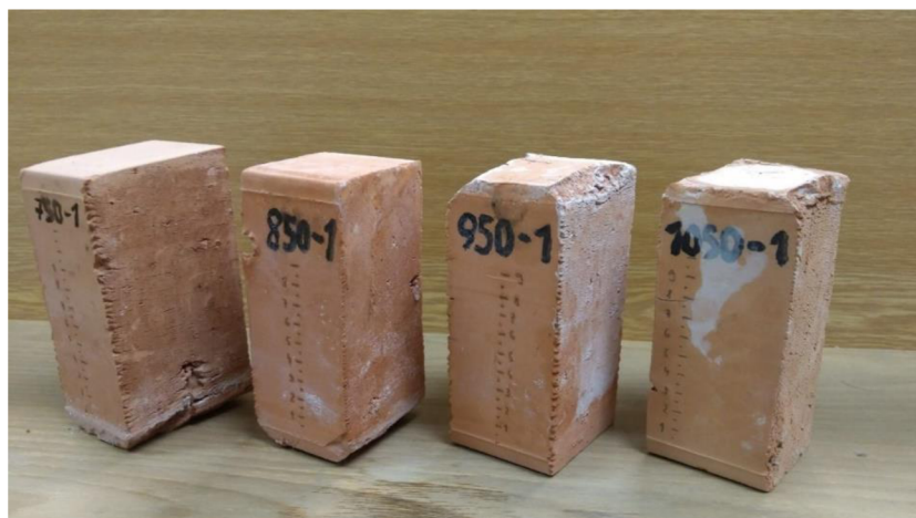
Obrázek 25 Výkvěty na vzorcích ze Šitbořic
