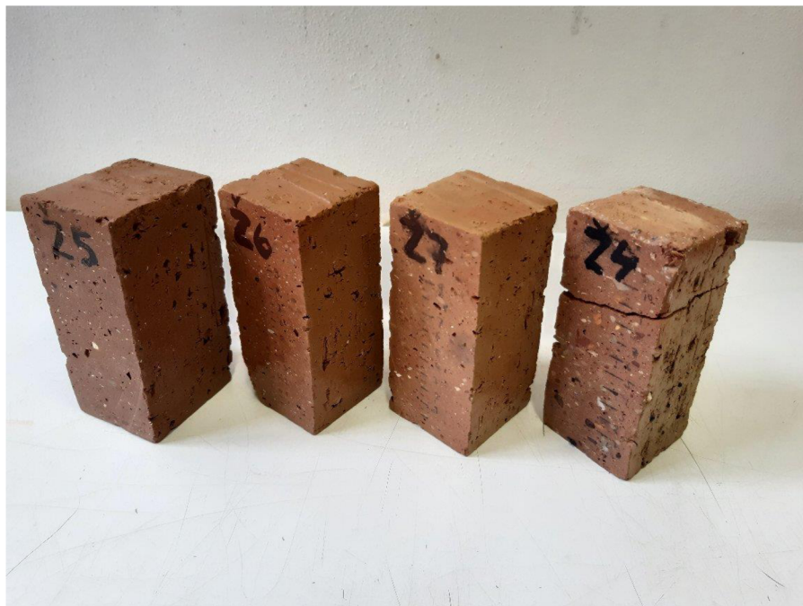
Obrázek 31 Vzorky Ž po zkoušce mrazuvzdornosti
