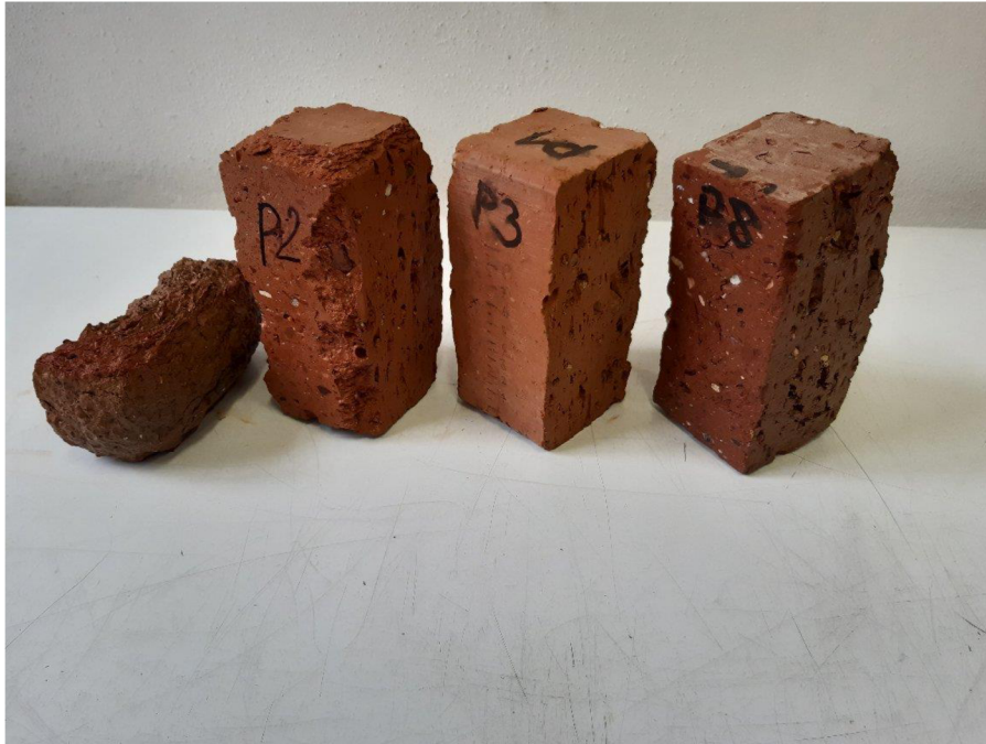
Obrázek 30 Vzorky P po zkoušce mrazuvzdornosti
