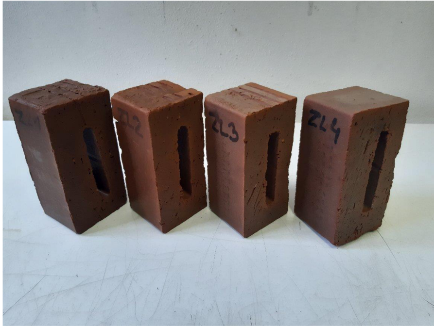
Obrázek 32 Vzorky ZL po zkoušce mrazuvzdornosti
