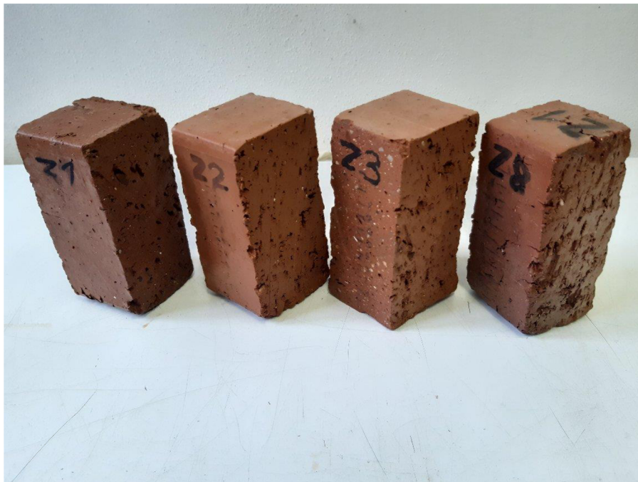
Obrázek 33 Vzorky Z po zkoušce mrazuvzdornosti
