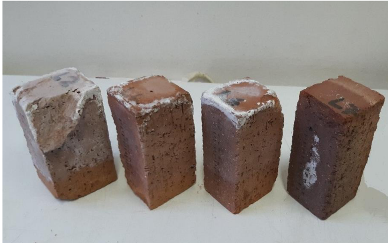
Obrázek 27 Výkvěty na vzorcích L
