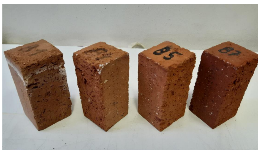
Obrázek 26 Výkvěty na vzorcích B
