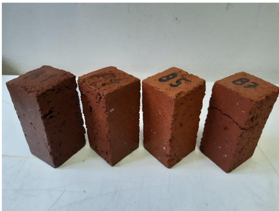
Obrázek 34 Vzorky B po zkoušce mrazuvzdornosti
