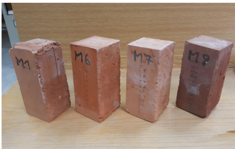
Obrázek 20 Výkvěty na vzorcích M
