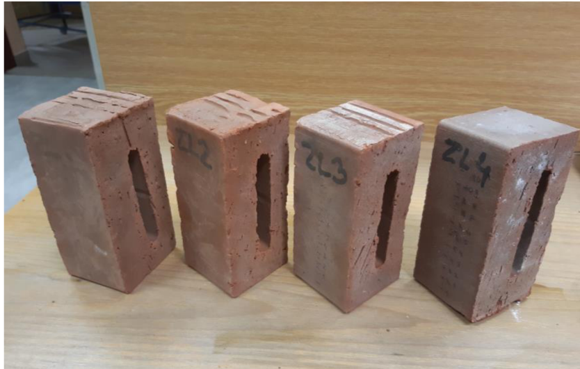
Obrázek 23 Výkvěty na vzorcích ZL
