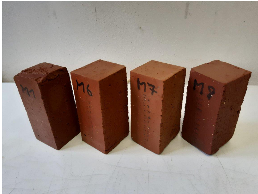
Obrázek 29 Vzorky M po zkoušce mrazuvzdornosti
