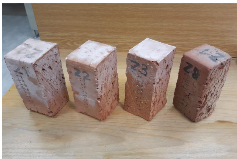
Obrázek 22 Výkvěty na vzorcích Z
