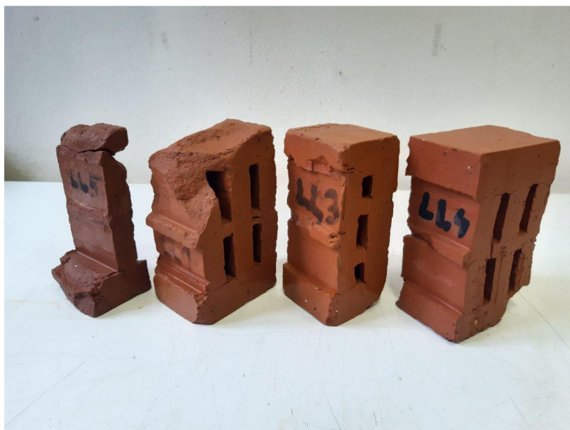
Obrázek 36 Vzorky LL po zkoušce mrazuvzdornosti
