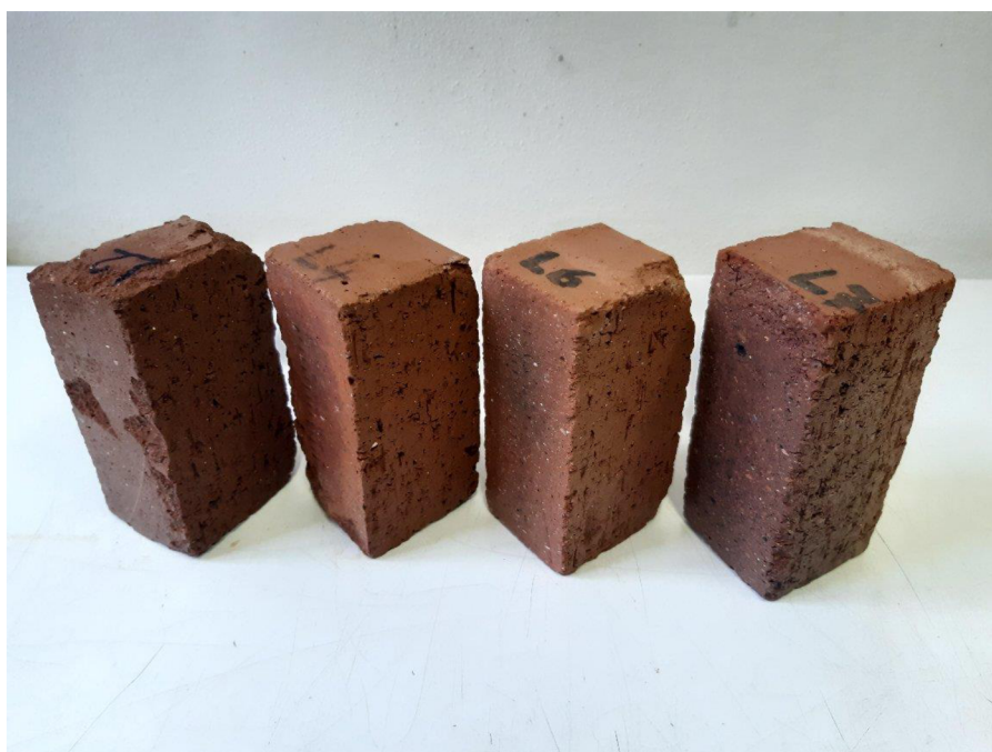
Obrázek 35 Vzorky L po zkoušce mrazuvzdornosti
