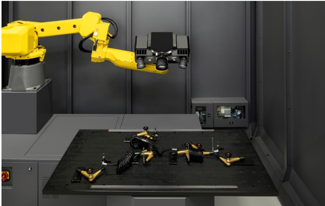
Obrázek 34: GOM pneumatický přípravek na měření ve volném stavu
