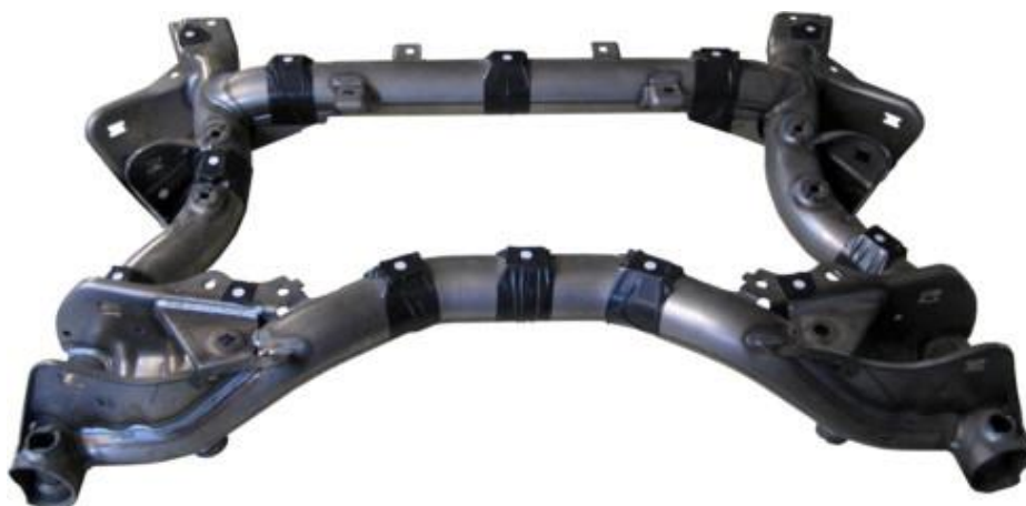
Obrázek 24: Měřený díl, pomocný rám z Mercedesu E-class [1]
