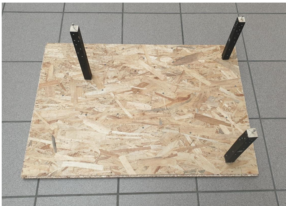
Obrázek 35: Vlastní měřicí přípravek pro měření ve volném stavu
