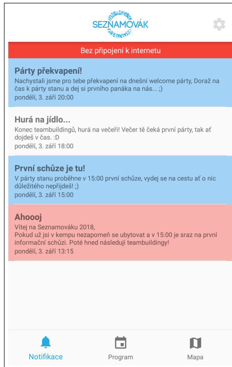
Obrázek 5.1: Na obrázku lze vidět aktivitu MainActivity s aktivním fragmentem NotificationFragment , která se stará o seznam notifikací. Je viditelný také panel, který značí, že zařízení není připojené k internetu.
