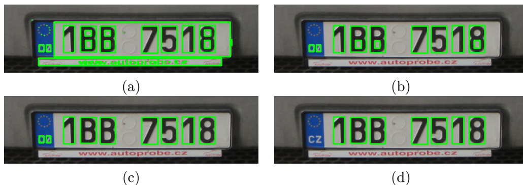
Obrázek 3.10: Ukázka postupu filtrování nalezených oblastí znaků. Na snímku a) jsou všechny nalezené oblasti, na snímku b) jsou vyřazeny oblasti nevyhovující definovanému poměru stran nebo plochy oblasti. Snímek c) je po odstranění překrývajících se oblastí a snímek d) po vyřazení oblastí s neodpovídající výškou
