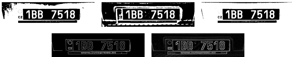
Obrázek 4.5: Výstup různých metod zvýraznění znaků - prahování s pevným prahem, adaptivní prahování, prahování metodou Otsu, Cannyho detektor hran, Sobelův operátor pro detekci hran
