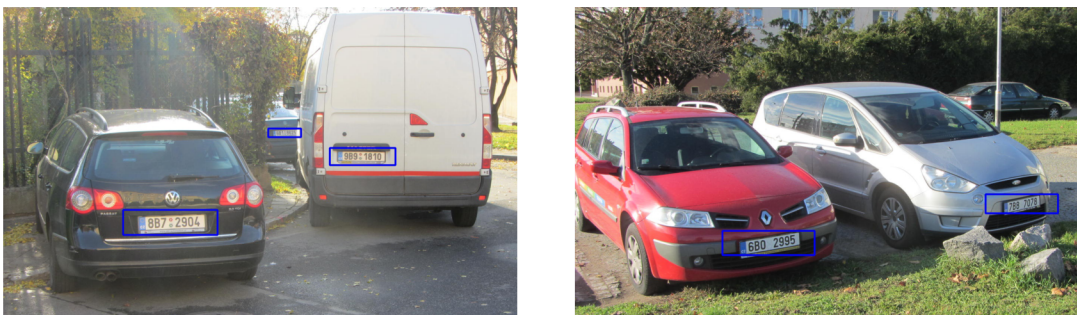
Obrázek 3.3: Oblasti detekované kaskádou klasifikátorů
