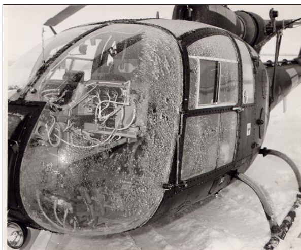
Obrázek 6 - Námraza na kabině vrtulníku Aérospatiale Gazelle 39
