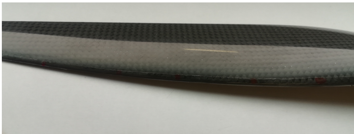
Obrázek 3.6: 17" vrtule s nalepenou izolepou sloužící jako turbulátor.
