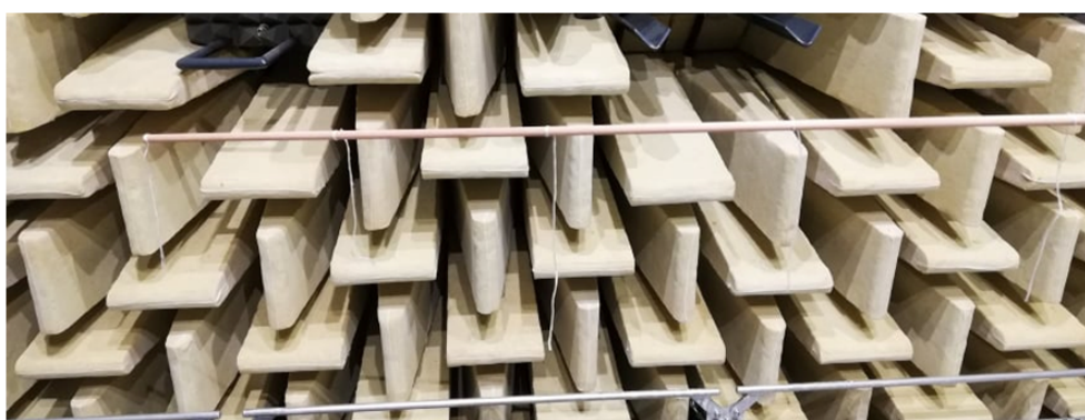
Obrázek 2.3: Fotografie hůlky s navázanými provázkami pro vizualizaci cirkulace vzduchu.
