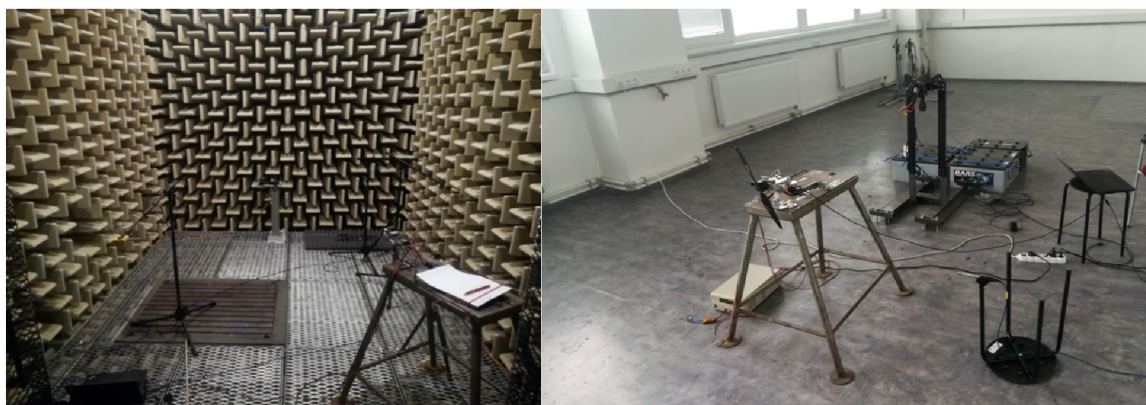
Obrázek 2.1: Ilustrační fotografie anechoické komory na ÚADI (vlevo) a prostoru firmy (vpravo), kde byla měření prováděna.
