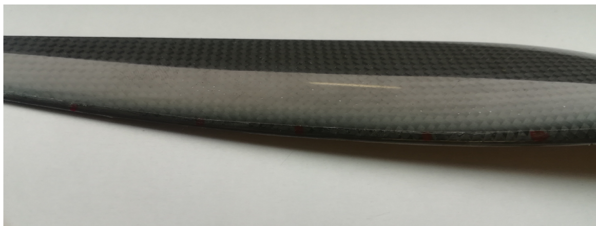
Obrázek 3.6: 17" vrtule s nalepenou izolepou sloužící jako turbulátor.
