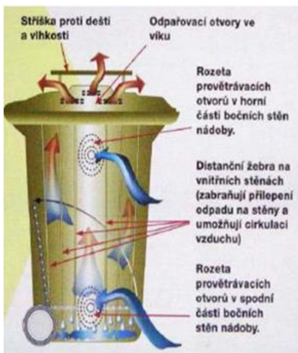
Obrázek 11 – Schéma speciální nádoby na bioodpad
