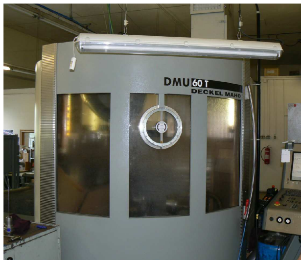
Obr. 6.8 Obráběcí centrum DECKEL MAHO DMU 60T
