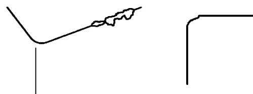
Obr. 3.13 Vydrolování ostří mimo záběr [1]
