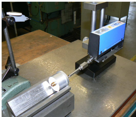
Obr. 6.11 Přenosný drsnoměr MAHR POCKET SURF III
