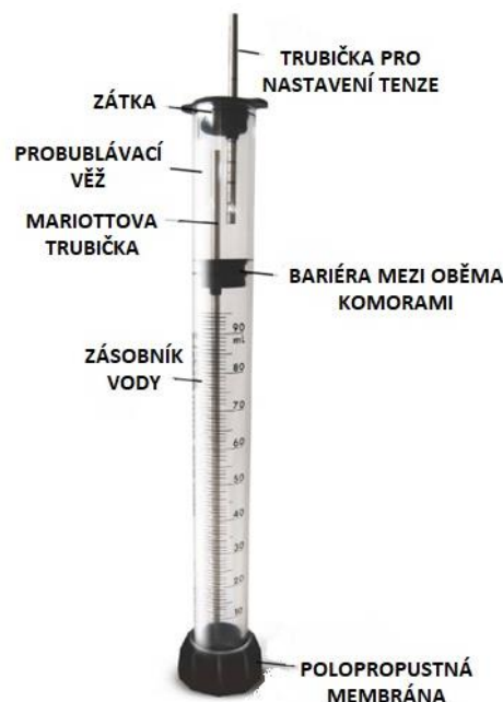
Obrázek 6 Popis Minidisk infiltrometru (upraveno podle METER group 2018).
