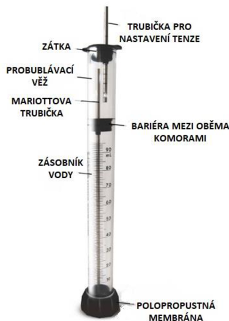
Obrázek 6 Popis Minidisk infiltrometru (upraveno podle METER group 2018).
