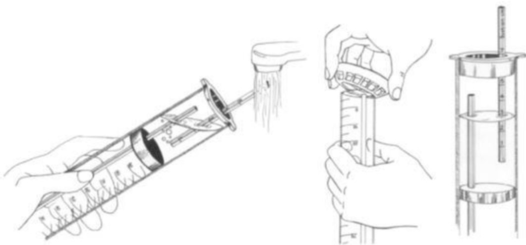
Obrázek 8 Obrázek Mini disk Infiltrometr, postup plnění vodou či etanolem (METER Group 2018).
