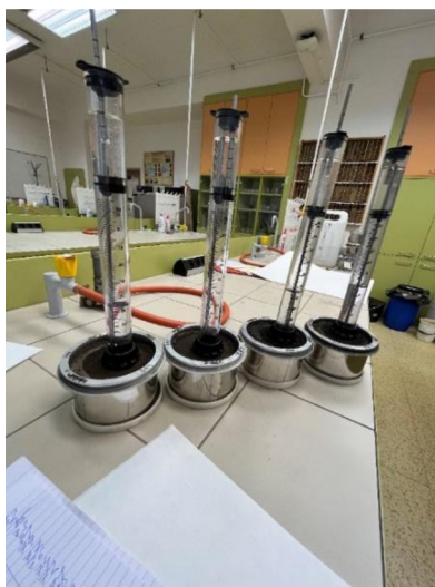
Obrázek 5 Minidisk infiltrometr METER Group během experimentu.
