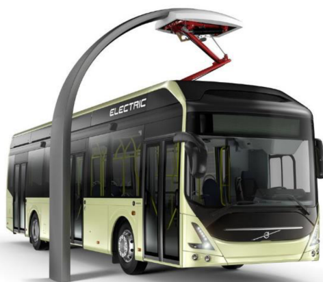
Obrázek 13 Volvo 7900 Electric + nabíjecí stanice Opportunity charge [33]
