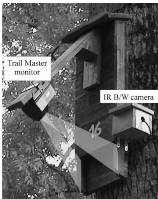
Obrázek 7: Budka projektovaná pro měření teploty, vlhkosti a obsazenosti (Bartonička a Řehák, 2007)
