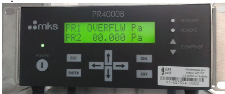
Obr. 2.14. Převodník měřky Baratronu PR4000B-F
