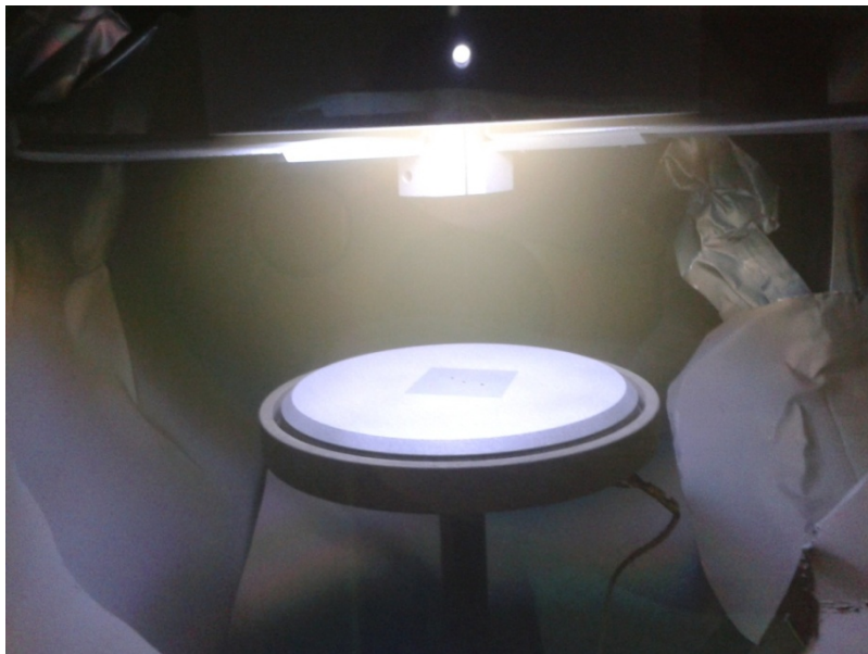
Obr. 2.15. Zapálený doutnavý výboj uvnitř komory aparatury PLS160
