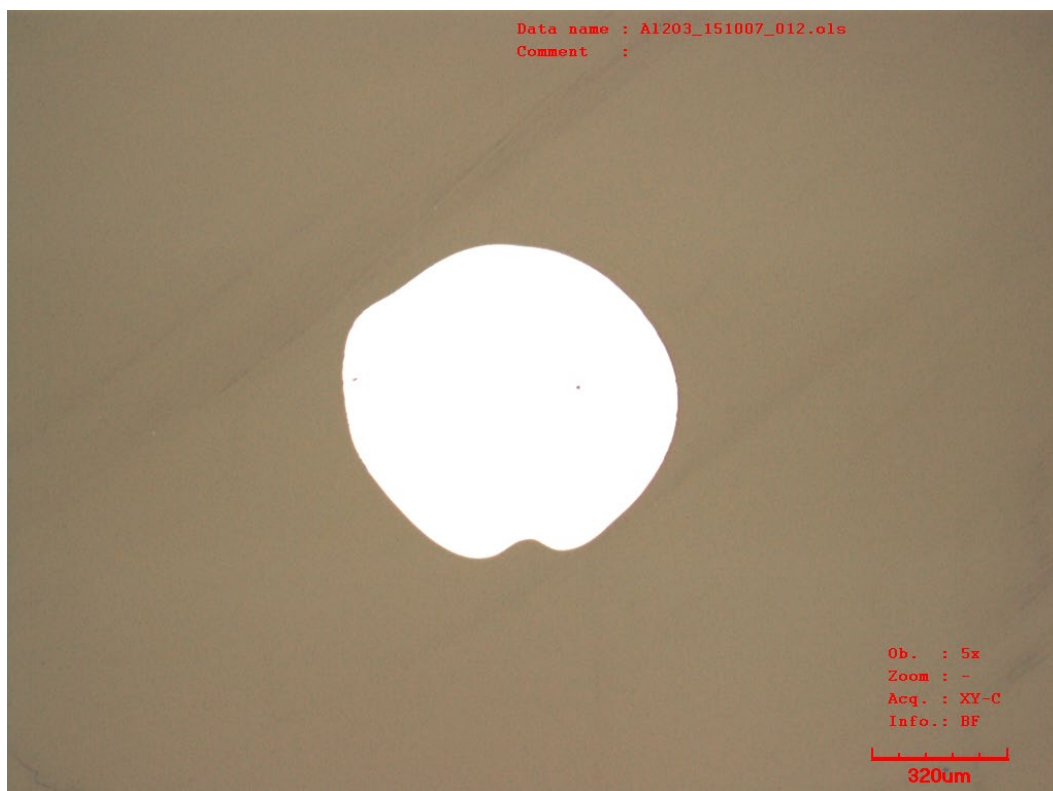
Obr. 3.9. Detail stechiometrické vrstvy \text{Al}_2\text{O}_3 _151007 po čištění ultrazvukem
