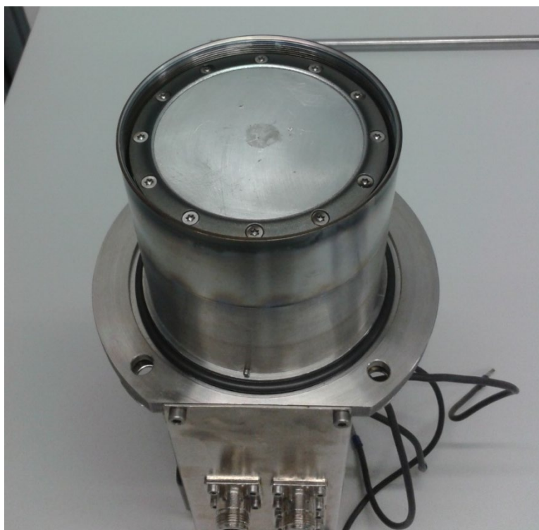
Obr. 3.2. Nový hliníkový terč nainstalovaný k magnetronu
