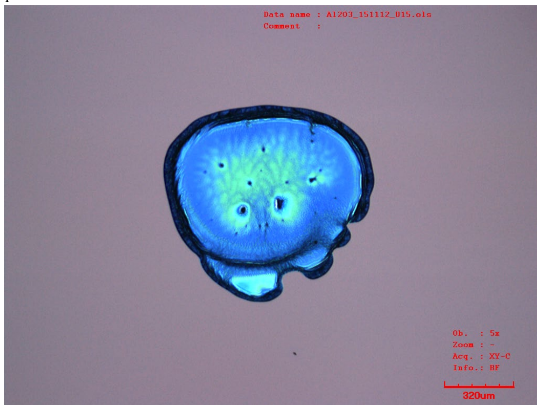
Obr. 3.13. Stechiometrická vrstva \text{Al}_2\text{O}_3 _151112 na křemíku
