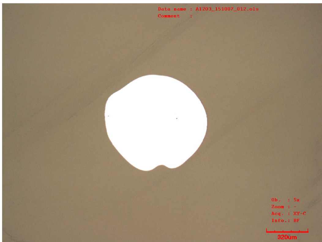
Obr. 3.9. Detail stechiometrické vrstvy \text{Al}_2\text{O}_3 _151007 po čištění ultrazvukem
