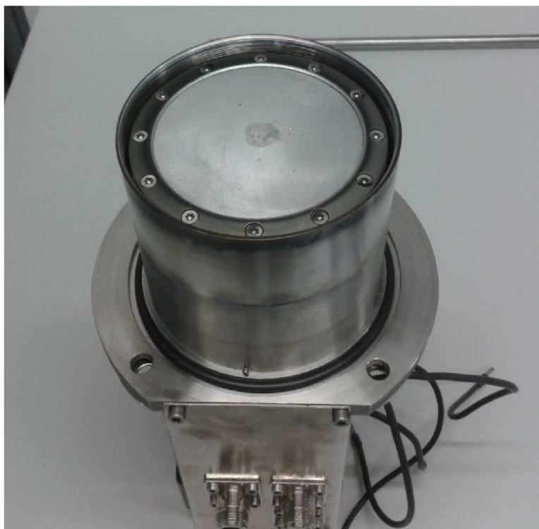
Obr. 3.2. Nový hliníkový terč nainstalovaný k magnetronu
