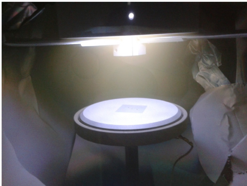
Obr. 2.15. Zapálený doutnavý výboj uvnitř komory aparatury PLS160
