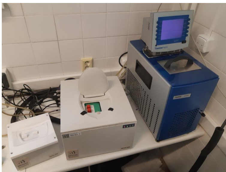
Obr. 6: Ultrazvukový spektrometr s vysokým rozlišením (HR-US 102 uprostřed a HR-EX-SSC vlevo) s termostatem Thermo Haake C25P (vpravo). Foto: autor práce
