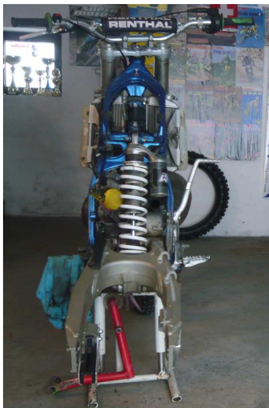
Obr. 1.2 Dvojitý rám motocyklu Kawasaki KX 250
