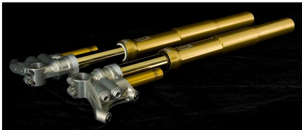
Obr. 8.2 Přední vidlice Öhlins FGR pro motocykly WSBK s technologií TTX
