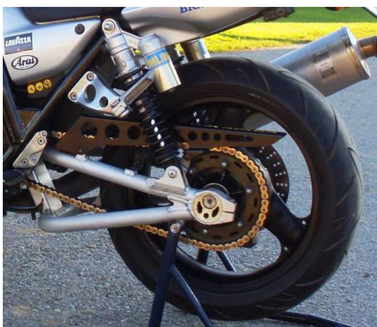
Obr. 2.4 Trojúhelníková příhradová konstrukce kývačky Kawasaki ZRX
