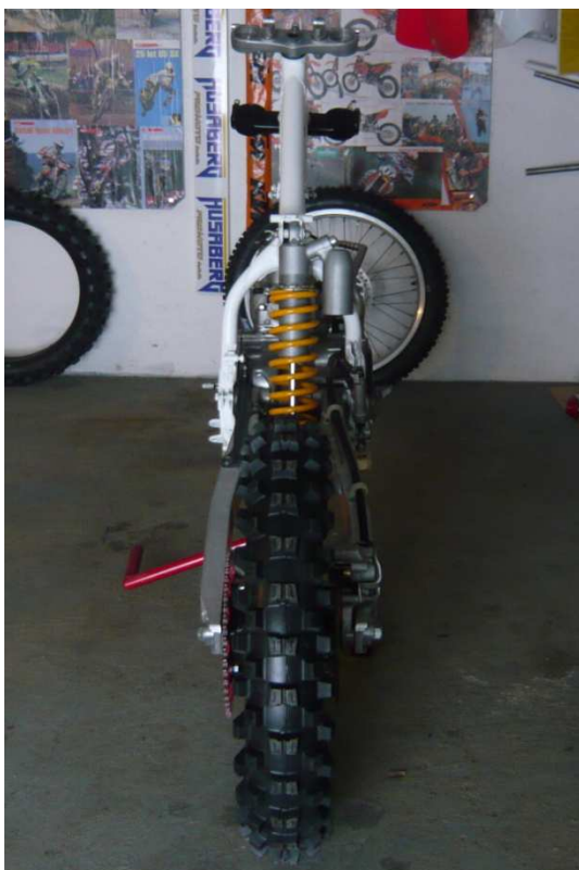
Obr. 1.1 Rozdvojený rám motocyklu Honda CR 500
