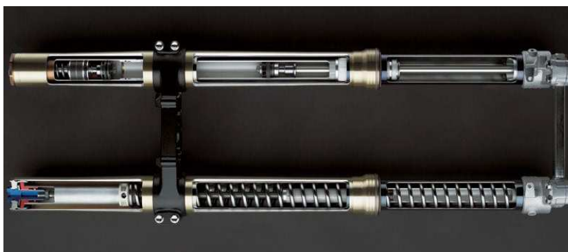
Obr. 7.2 Řez přední vidlicí stroje Kawasaki KX 250f
