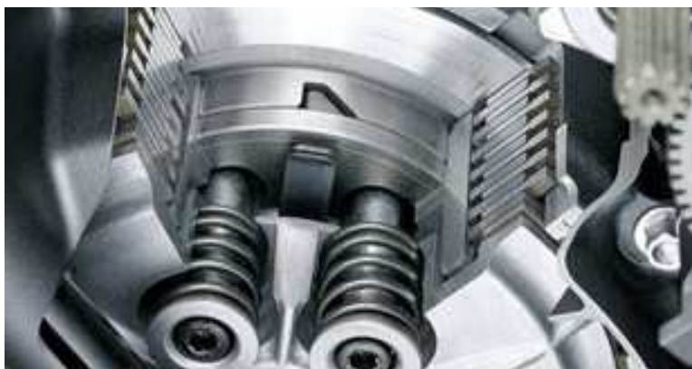
Obr. 8.5 Anithoppingová úprava spojky motocyklu Kawasaki Ninja ZX-6R
