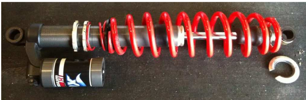
Obr. 2.1 Progresivní uložení pružin v tlumiči Makin Trax
