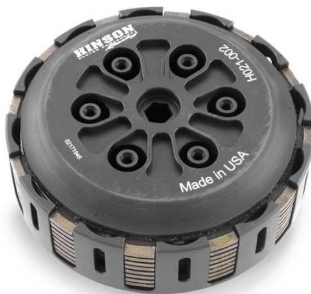
Obr. 7.5 Závodní spojka Hinson pro nejvyšší výkony
