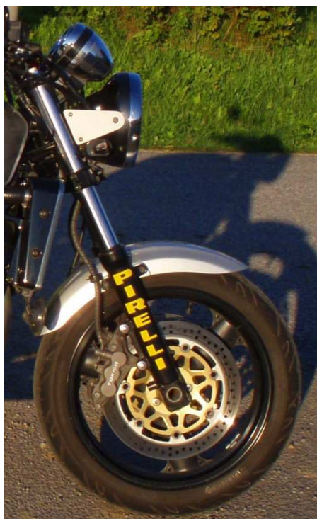
Obr. 2.2 Teleskopická vidlice Sachs motocyklu ZRX 1100
