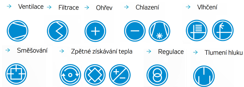
Obr. 8 Symboly označení vzduchotechnických prvků a příslušenství [30]
