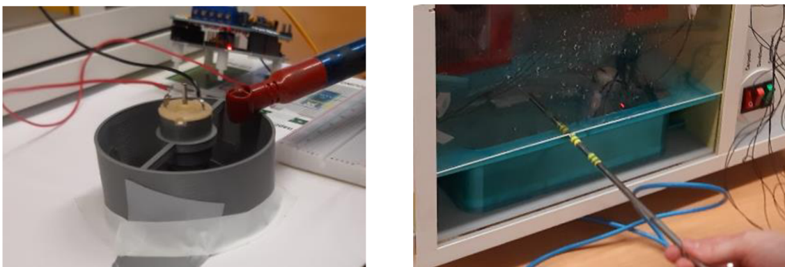
Obr. 57 Vrtulový a žahavý anemometr
