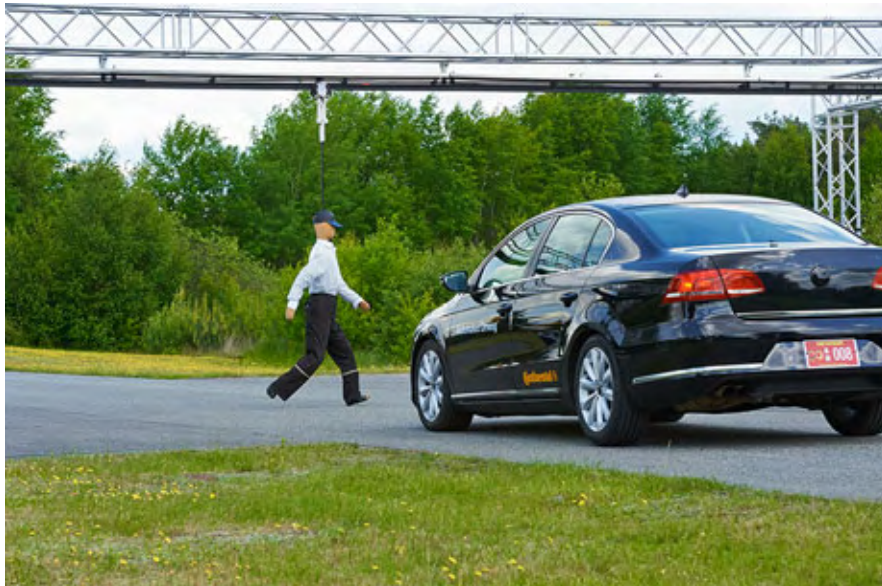
Obrázek 4.3: Portálový testovací systém pro figurínu chodce, od společnosti Continental Safety Engineering, Německo [3]
