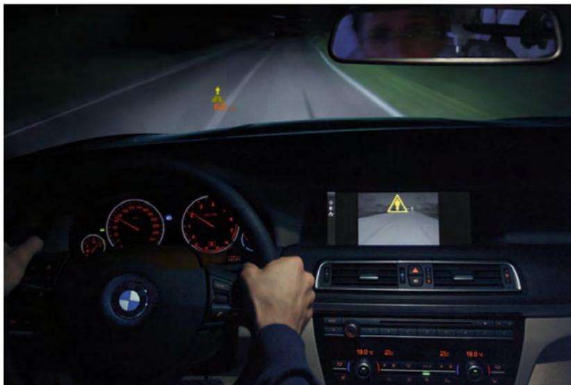
Obrázek 2.7: Noční vize s varováním o chodci, zobrazena na přístrojové desce vozu značky BMW [3]
