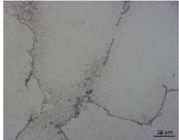
Obr. 40a: Vzorek č. 19DL ( 850°C/235 MPa) Obr. 40b: Vzorek č. 19HL ( 850°C/235 MPa)
