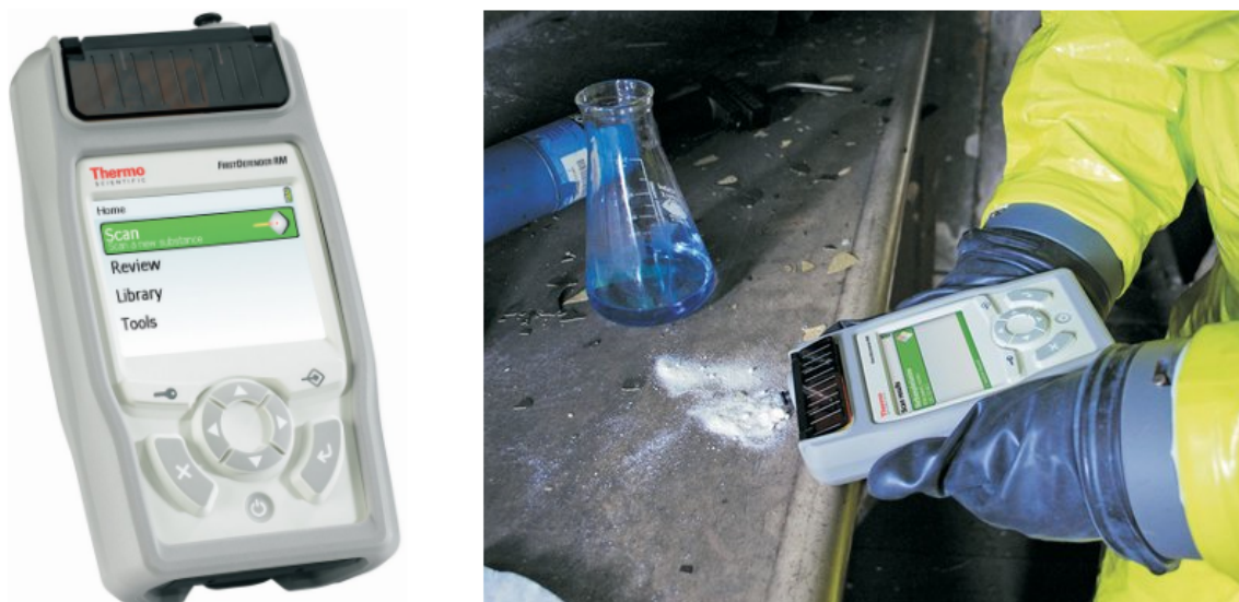
Obrázek 5: Přenosný Ramanův spektrometr FirstDefender RM a ukázka jeho využití při identifikaci neznámé látky (upraveno podle [28]).
