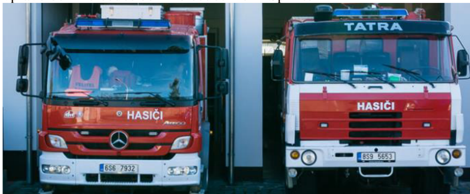
Obrázek 9 požárnické vozidlo CAS 15 Mercedes-Benz Atego vlevo a CAS 32 TATRA 815 vpravo bez mercedes bez Mercedes-Benz Sprinter
