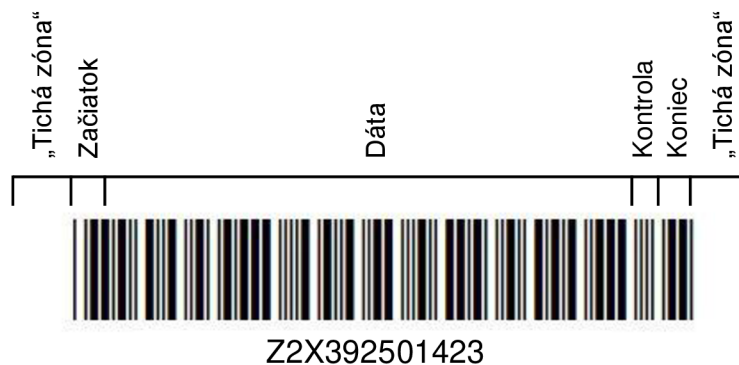
Obrázok 4.4 Čiarový kód typu 128 – označenie konkrétneho VZV.
