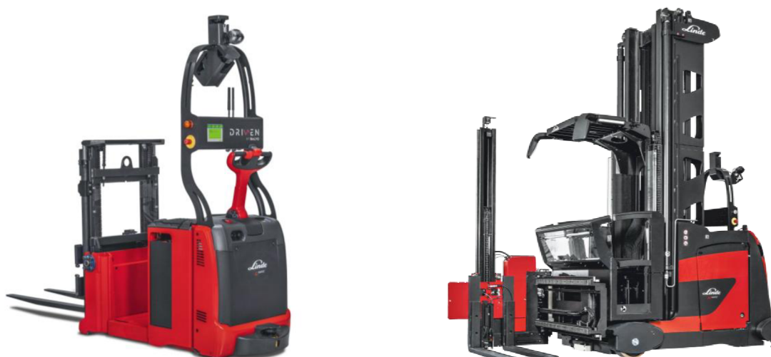
Obrázok 1.1 Autonómne riadené vysokozdvížné vozíky [12].
