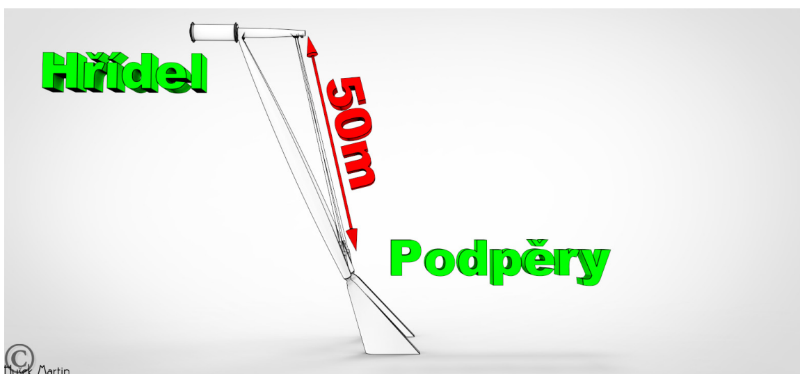
Obrázek 6.3 Kotevní lana spojující hřídél s podpěrami. (hřídél → podpěry)
