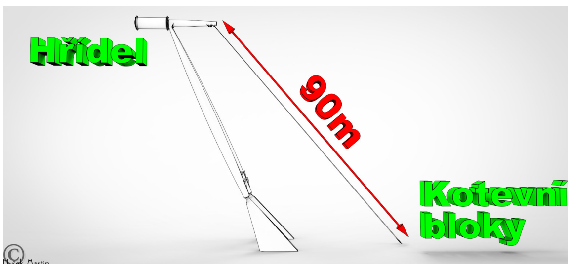
Obrázek 6.2 Kotevní lana spojující hřídél s kotevními bloky. (hřídél → kotvení)
