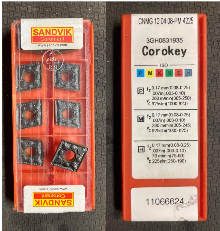
Příloha 24 Doporučené řezné rychlosti a otáčky za posuv od výrobce Sandvik Coromant
