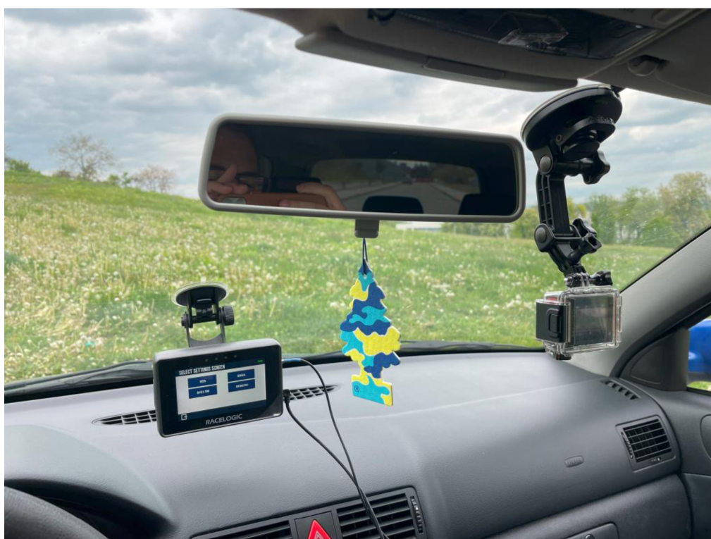
Obrázek 9: Kamera Garmin umístěná ve vozidle s VBOXem Performance Box Touch
