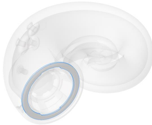
Obr. 41 Výztuž satelitu vložená mezi ozvučnici a koš reproduktoru
