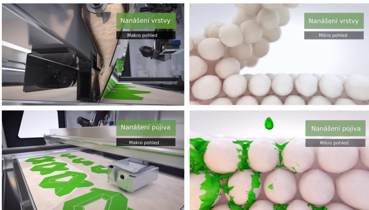
Obr. 22 Princip 3D tisku z písku [51]
