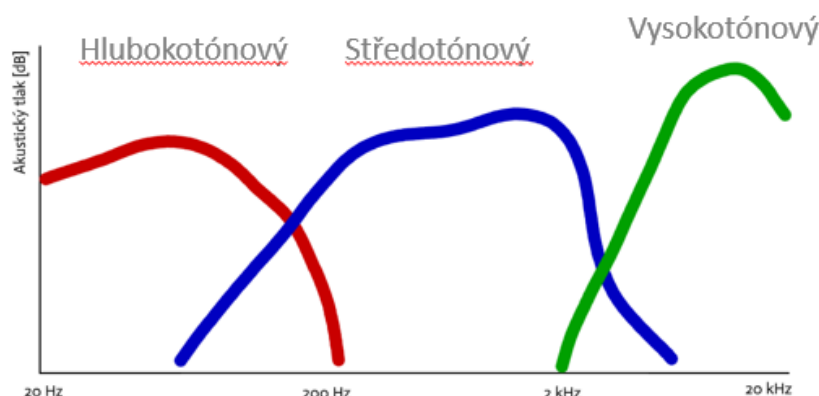
Obr. 13 Fungování výhybky a dělení signálu mezi reproduktory [23]
