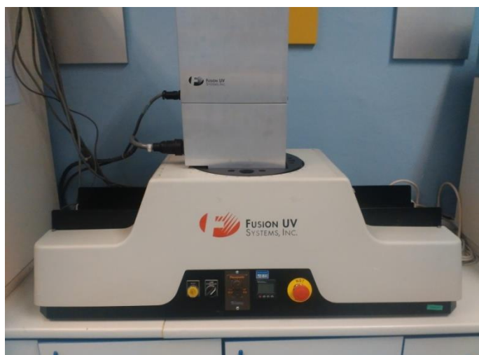
Obr. 8: UV vytvrzovací zářič s LED lampami – vlastní fotografie
