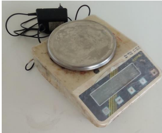
Obr. 1: Laboratorní váhy – vlastní fotografie
