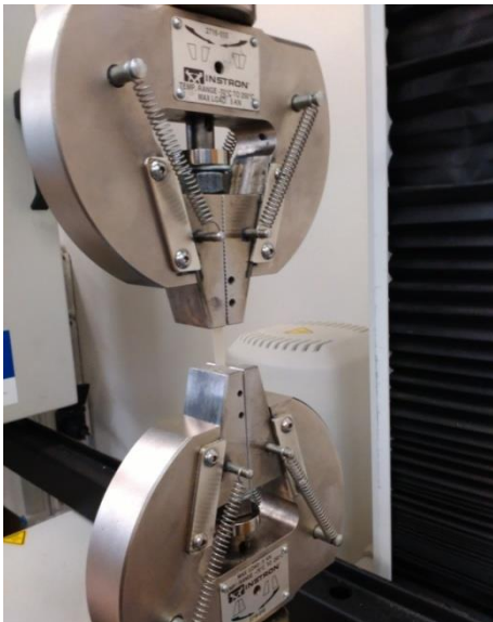
Obr. 6: Čelisti trhacího zařízení - vlastní fotografie
