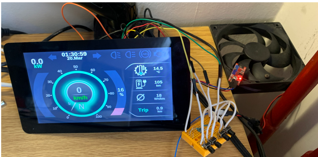
Obrázek 21: Testování měření parametrů získávaných z Hallova senzoru a funkčnost ovládacích tlačítek v rámci simulace
