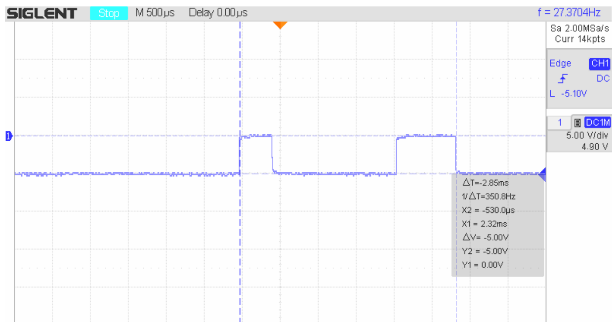
Obrázek 13: Detekce signálu přítomnosti magnetu Hallova senzoru
